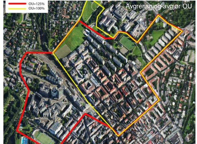
Majorstua, Oslo kommune. Eksempel på hvordan avgrensning kan påvirke områdeutnyttelsesgraden. Illustrasjonen er hentet fra Plan- og bygningsetaten.
