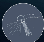
Lys integrert i rekkverkets håndloper. Lys er ned på gangflaten, hindrer blinding og gir et annet lys enn den hurtige gang-/sykkelveien langs Bybanen
